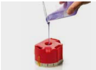
5. Pour Elite Double 16 into the flask
